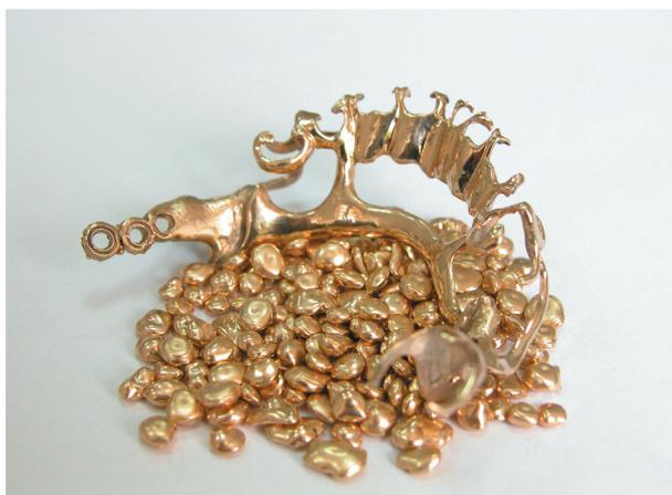
**Рис. 4.2.** Золотой сплав «Касдент» для цельнолитых конструкций
