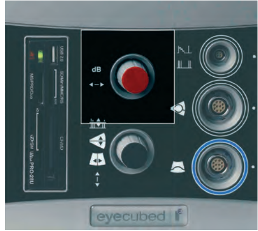
Рис. 2.3 Регулировка коэффициента усиления (измеряется в децибелах) используется для изменения интенсивности отображаемого эхо-сигнала. Офтальмологическая ультразвуковая система Eye Cubed™. (Цит. по: Ellex Innovative Imaging, Миннеаполис, Миннесота, США; с разрешения.)
